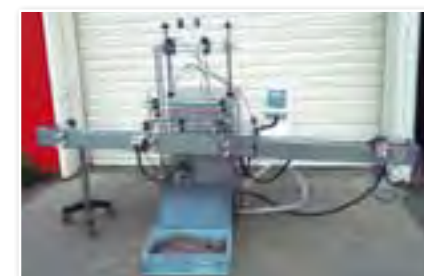
3A 3219 EUROFILL 2 head liquid filler
